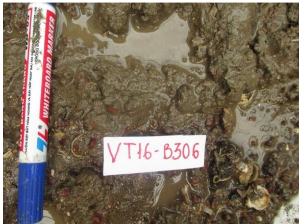
Ảnh 1. Trầm tích sạn cát bùn màu xám -xám nâu tại điểm VT16-B306 (Ảnh: Phan Văn Bình).
